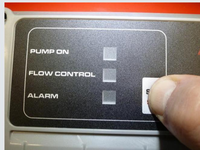
Nun den Netzstecker der Pumpe am Stromkreis anschliessen
